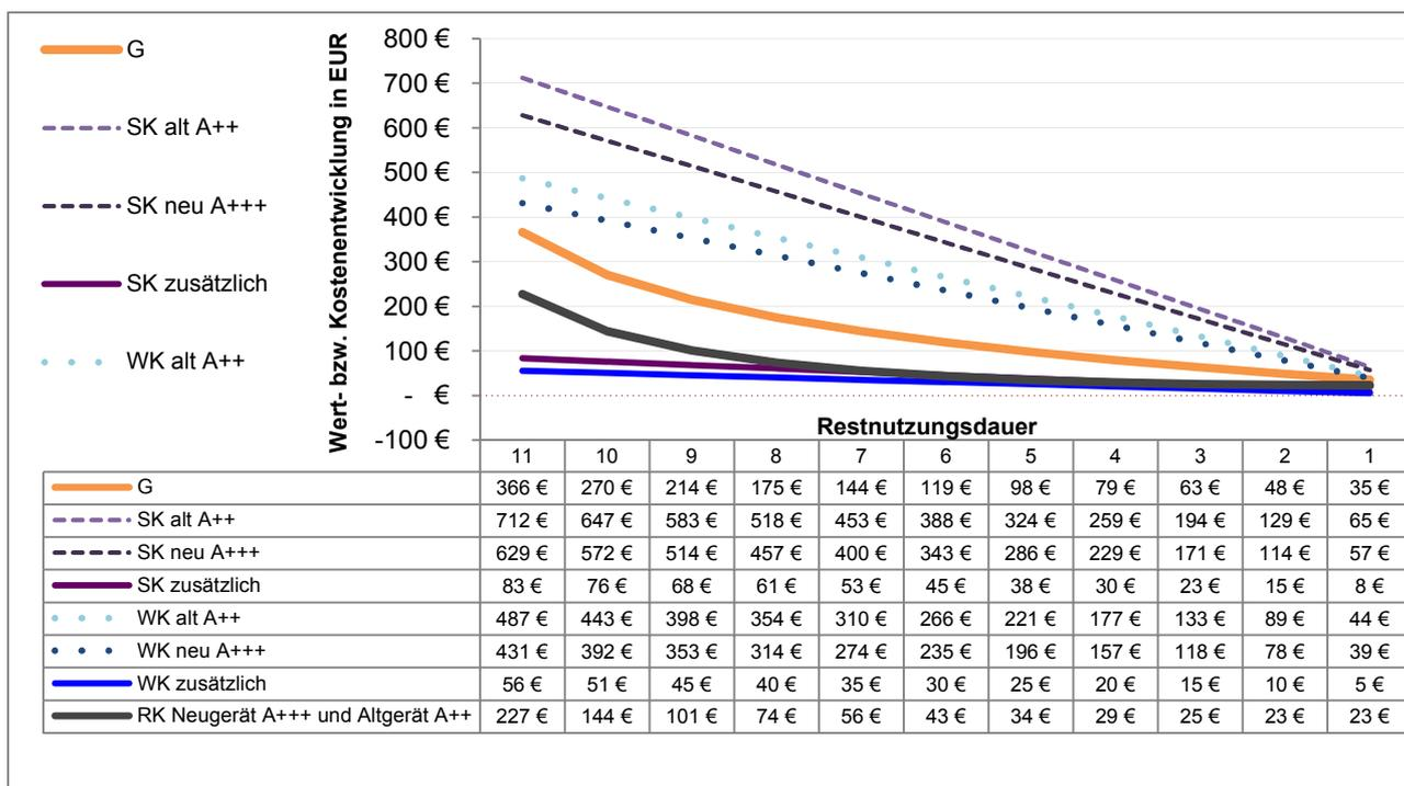
Abbildung 4 Schematische Berechnung der Reparaturkosten für eine Waschmaschine
